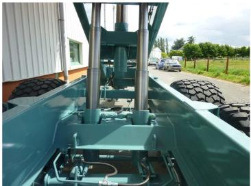
Elévation réalisée à l'aide de 2 vérins télescopiques
