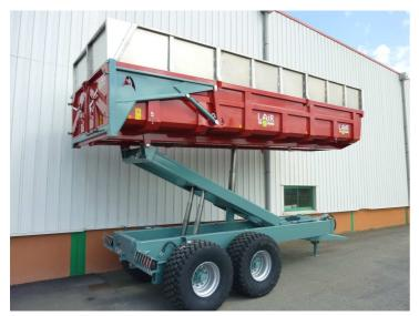
Châssis principal en 300/100/10mm Châssis de caisse en 200/200/10mm
